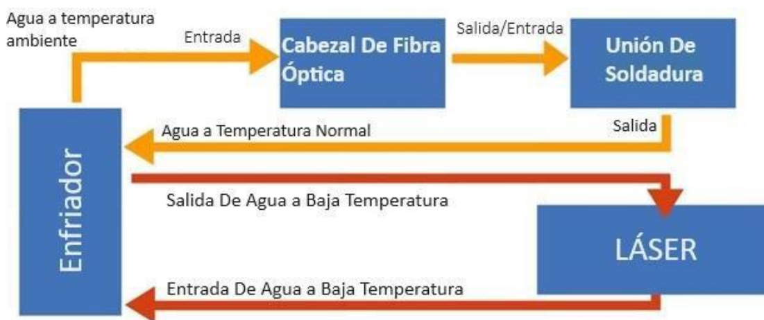
Figura 2.2 Diagrama esquemático del recorrido del agua entre el cabezal de soldadura y el cabezal de fibra óptica.
